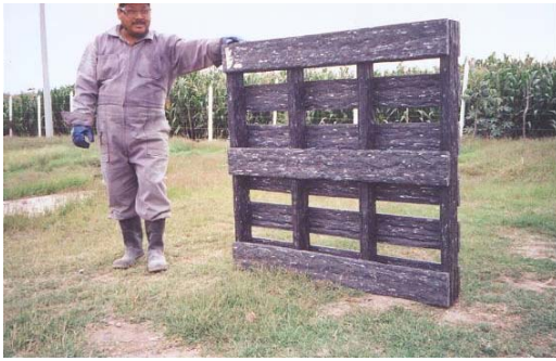
Figura 18. Tarima industrial fabricada con plástico de envase de plaguicida.
