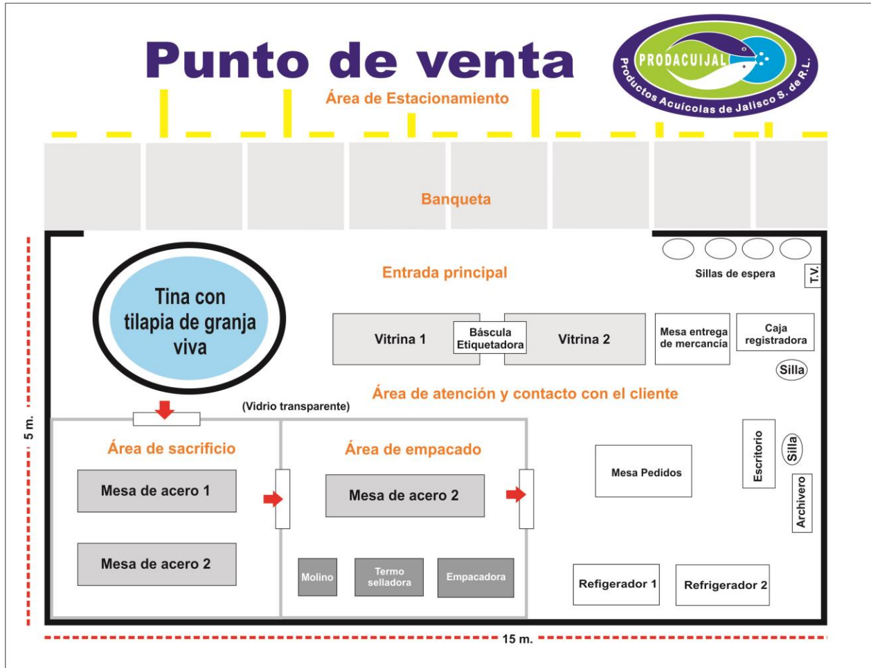
Figura 35. Plano de instalaciones, distribución de las áreas y equipos del punto de venta PRODACUIJAL Fuente: Elaboración propia
