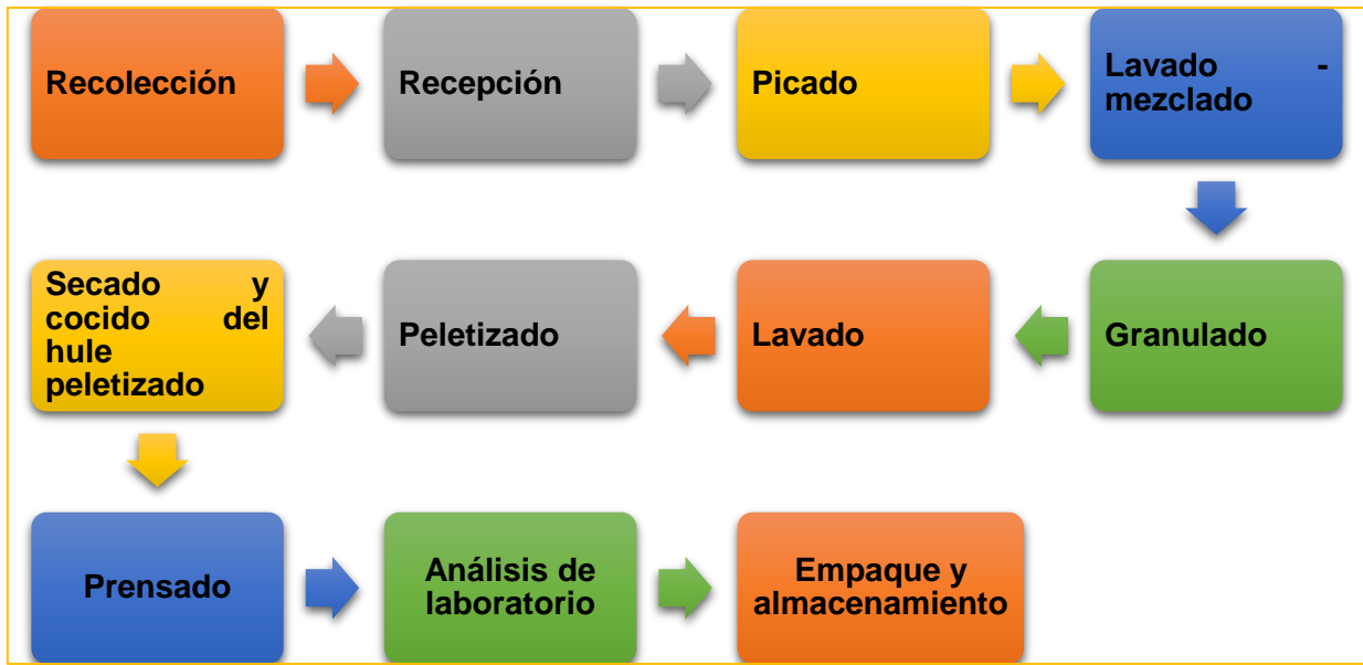
Figura 14. Proceso para producción de hule TSR 20.
