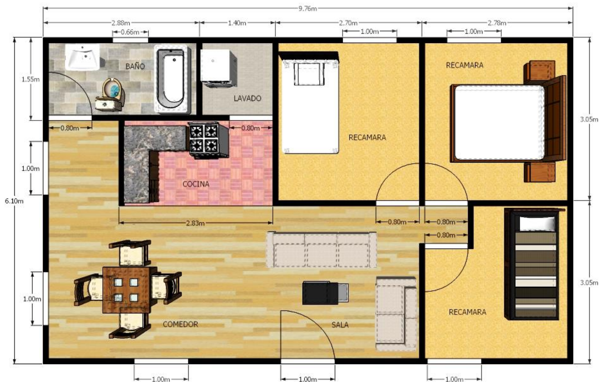
Figura 9. Dimensiones y distribución de ambientes para el prototipo de clima seco, elaborado en sketch Up v. 2017.
