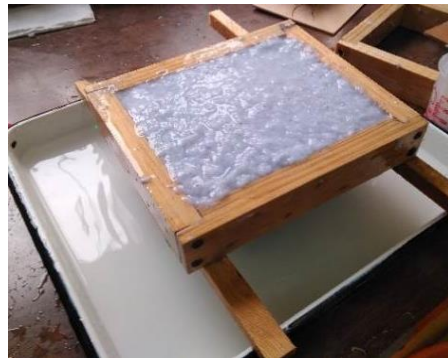
Figura 16. Pulpa de celulosa reciclada colocada en los moldes.
