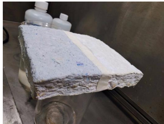
Figura 19. División del panel en dos fragmentos para aplicación de la disolución
