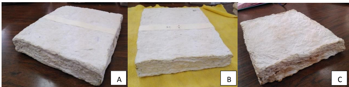
Figura 25. A) Muestra de panel de celulosa-unicel, B) Muestra de panel de celulosa, C) Muestra de Panel de celulosa-acículas de pino.
