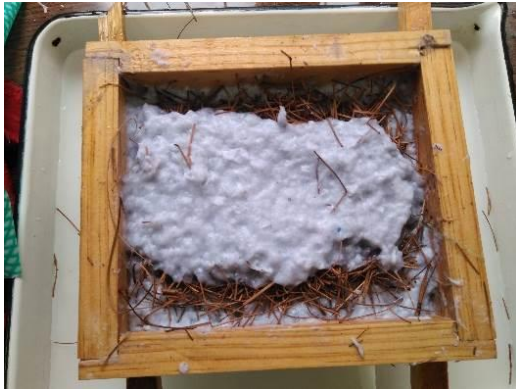
Figura 17. Elaboración de un panel con capa intermedia de acículas de pino.
