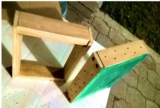
Figura 15. Moldes elaborados en madera, con perforaciones para facilitar el drenado de agua.
