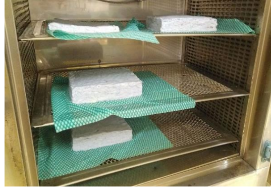
Figura 18. Paneles colocados en la mufla para su secado a 30° C.
