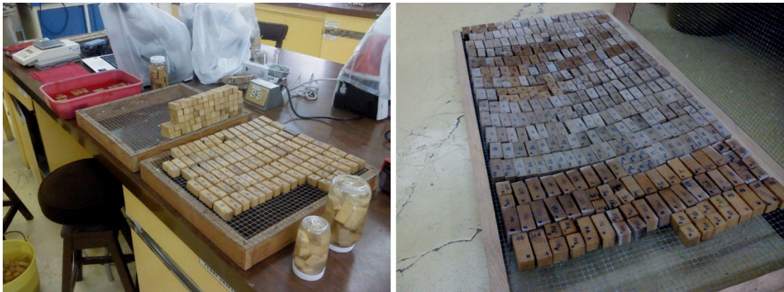
Figura 9. Conjunto de probetas prismáticas.
