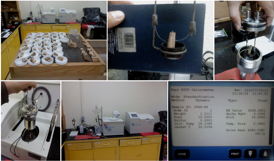
Figura 10. Astillas, calorímetro y poder calorífico.
