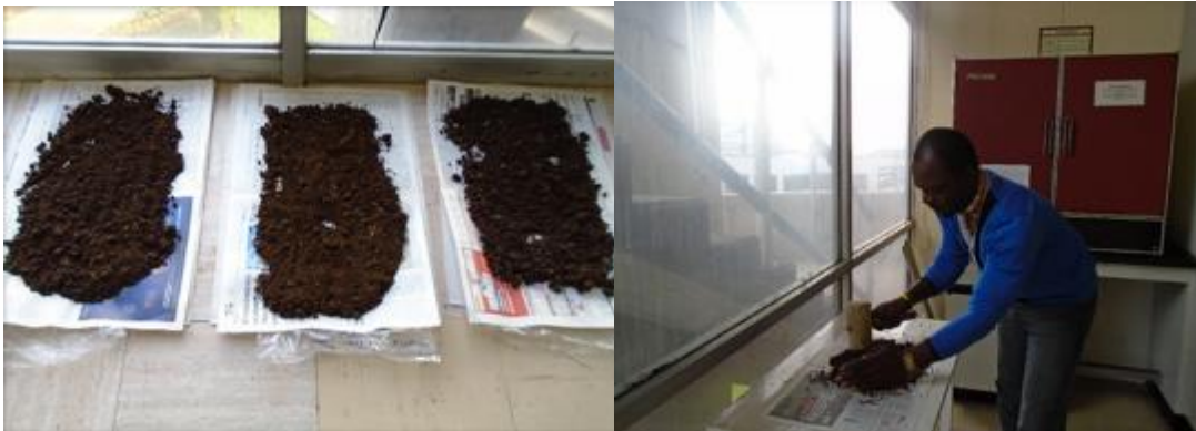
Figura 3. Procedimientos de preparación de las muestras de suelo.
