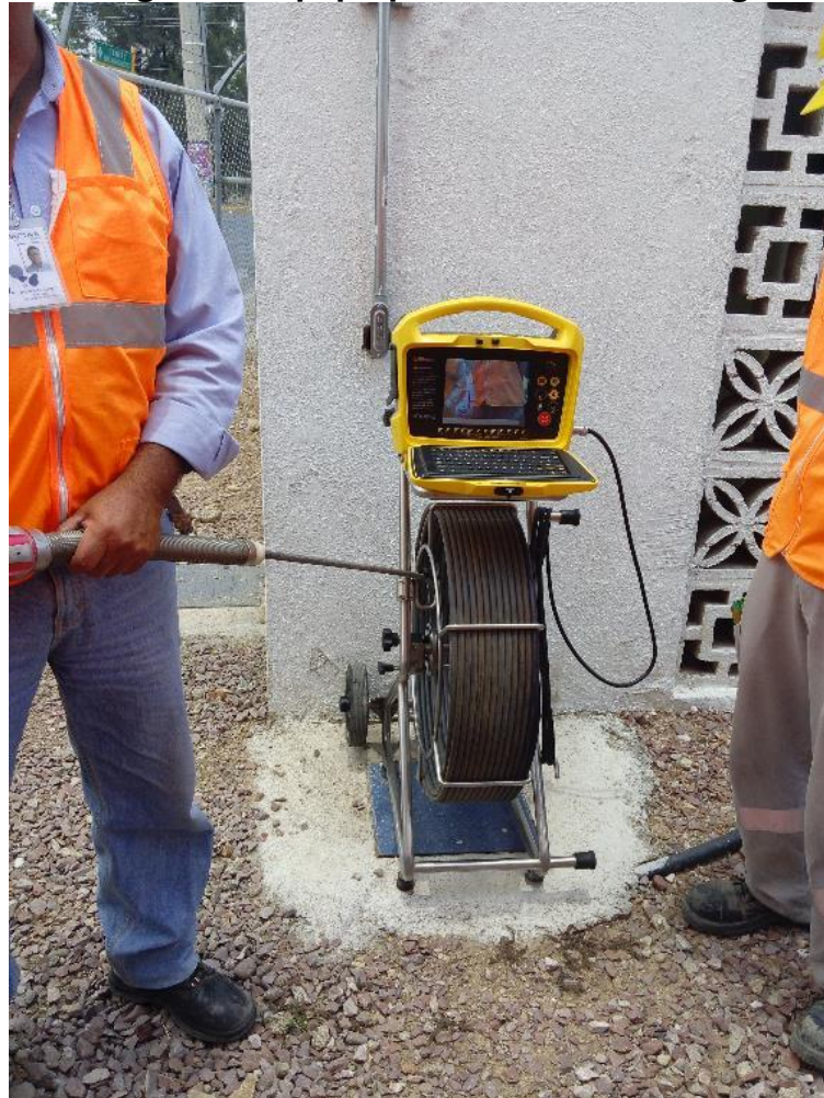
Figura 9. Equipo para detección de fugas
