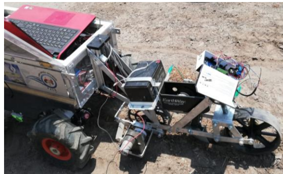
Figura 19. Prueba de funcionamiento sistema de siembra y arrastre del Robot agricultor.
