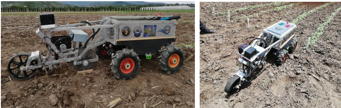
Figura 24. Conjunto Robot-Sembradora agricultor Voltan. Fuente: elaboración propia.
