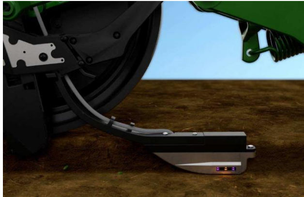
Figura 6. Lengüeta fijadora de semilla SmartFirmer . Fuente: Bragachini et al. (2017).
