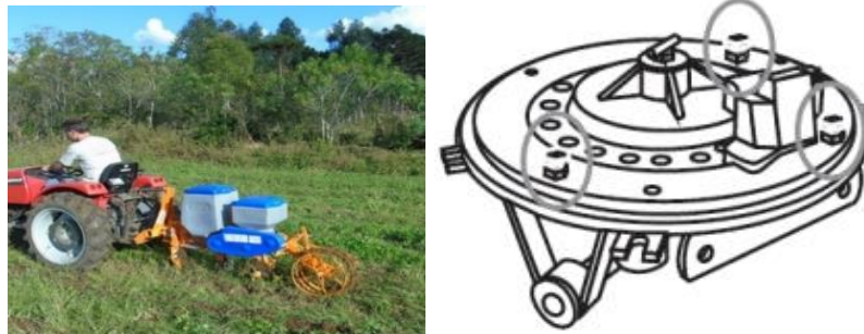
Figura 1. Sembradora de plato horizontal. Fuente: Knapik (2013).
