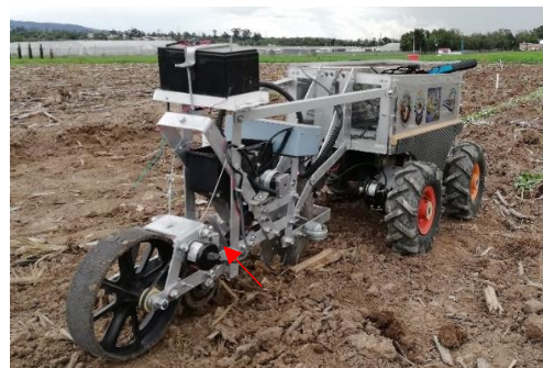
Figura 21. Sistema de control de profundidad.
