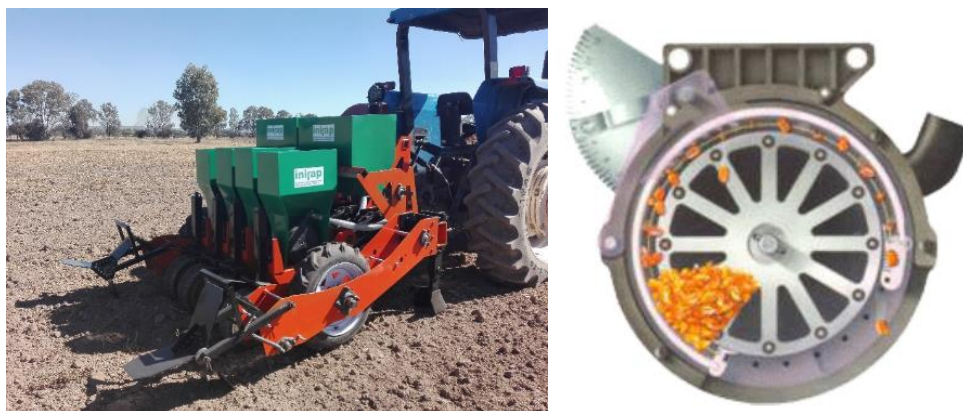
Figura 4. Sembradora neumática de granos medios para siembra en camas. Fuente: Garibaldi, et al. (2017).
