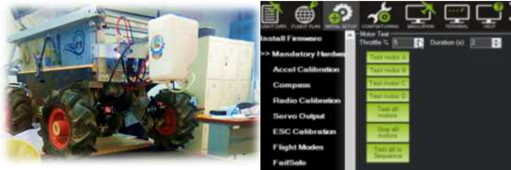
Figura 6: Verificación del sentido de giro de los motores.
