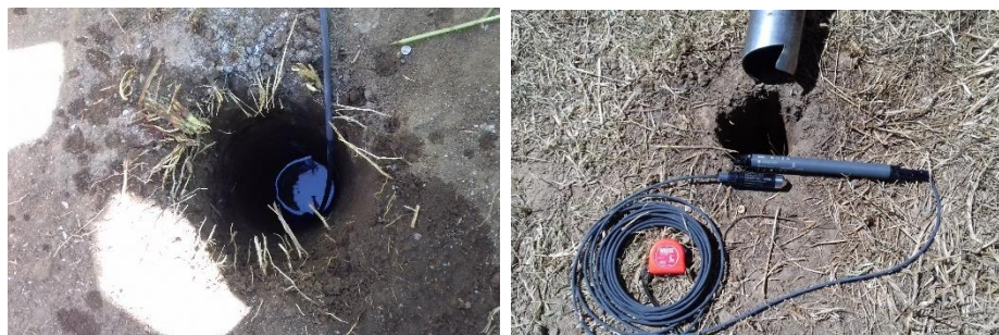
Figura 11. Determinación de conductividad hidráulica.
