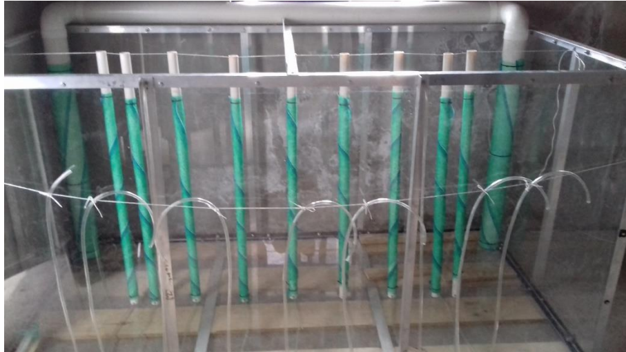
Figura 23. Instalación de Pozos de Observación y piezómetros
