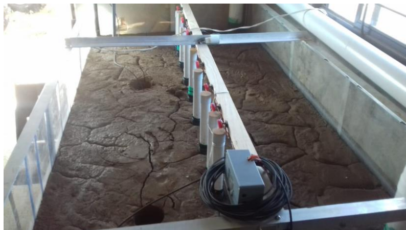
Figura 28. Pozos para medir la conductividad hidráulica
