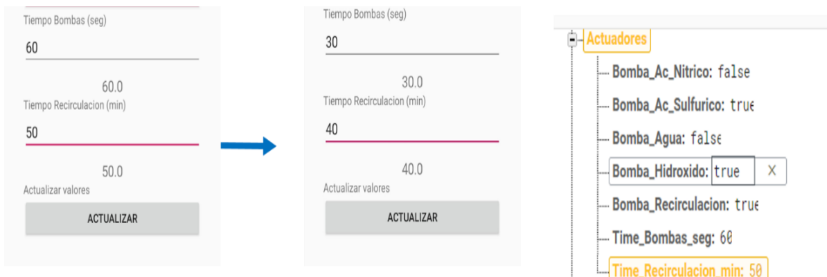
Figura 44. Cambio de tiempo de encendido de bombas desde la aplicación Android.
