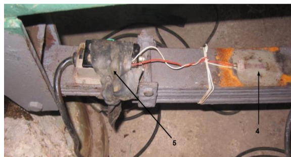
Figura 6.8. Sistema de suspensión tipo ballesta preparado para las pruebas experimentales.
