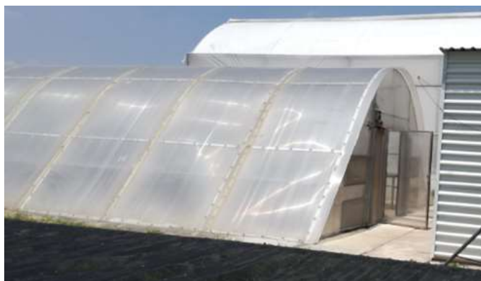
FIGURA 35. SECADOR SOLAR EXPERIMENTAL CON CUBIERTA PARABÓLICA DE POLICARBONATO.
