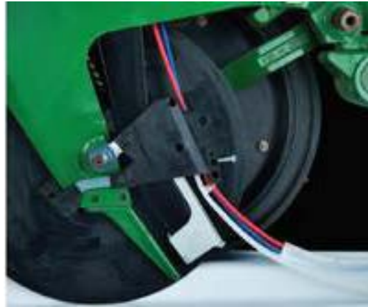
b) Colocación del sensor en la sembradora
