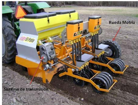
Figura 2. Accionamiento de los dosificadores de la sembradora por un sistema de transmisión mecánico.
