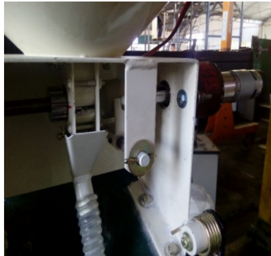
b) Fijación del motor al dosificador de pesticida.
