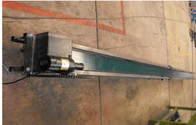
b. Banda transportadora construida.
