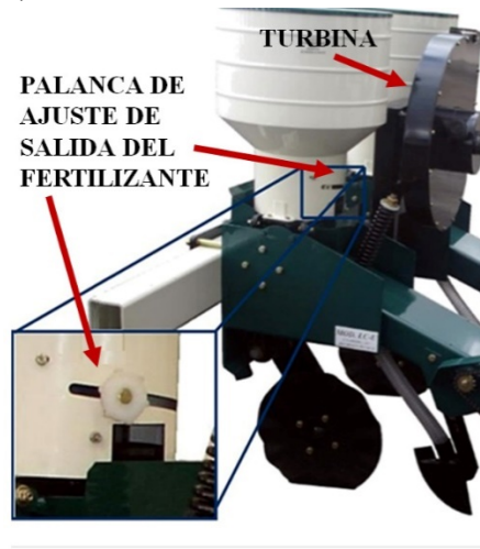
e) Perilla de ajuste de salida del fertilizante.
