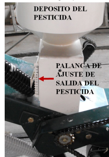
f) Palanca de ajuste de la salida del pesticida.
