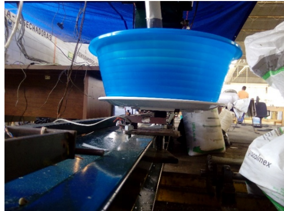
b. Bascula fijada para medir la masa de fertilizante.
