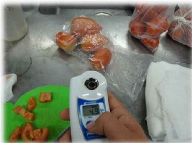
Figura 4. 18. Mediciones de grados Brix.
