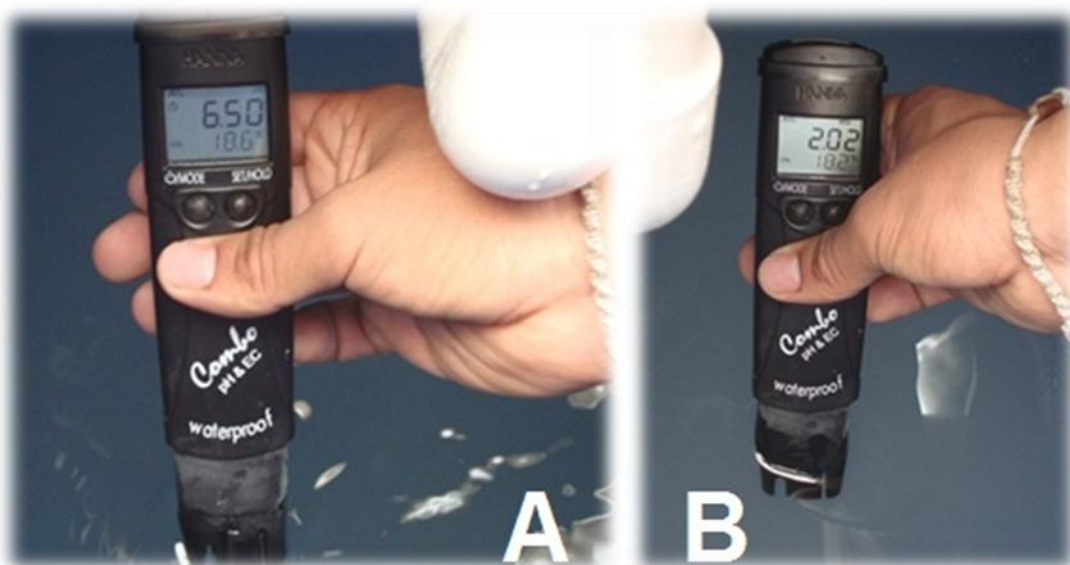
Figura 4. 13. A) pH y B) Conductividad eléctrica ajustados en la solución nutritiva.
