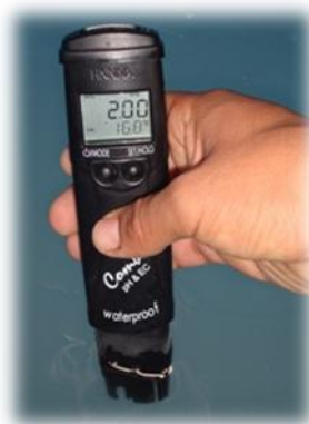
Figura 4. 8. Medición y ajuste de CE dentro de la solución nutritiva.
