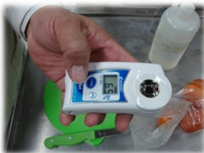
Figura 4. 17. Refractómetro en medición de Grados Brix.
