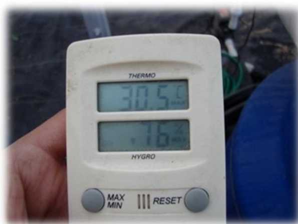
Figura 4. 16. Termohigrometro para registro de humedad relativa y temperatura del aire.
