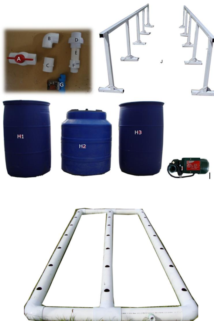
Figura 4. 3. Materiales utilizados; A) válvula globo, B) Codo de 90 C) adaptador hembra, D) Tuerca unión, E) Tubo de PVC, F) Adaptador macho, G) Relevador con base, H1,H2 y H3 Tambos de 200 L, I) Bomba de \frac{1}{2} HP, J) Estructura de soporte.
