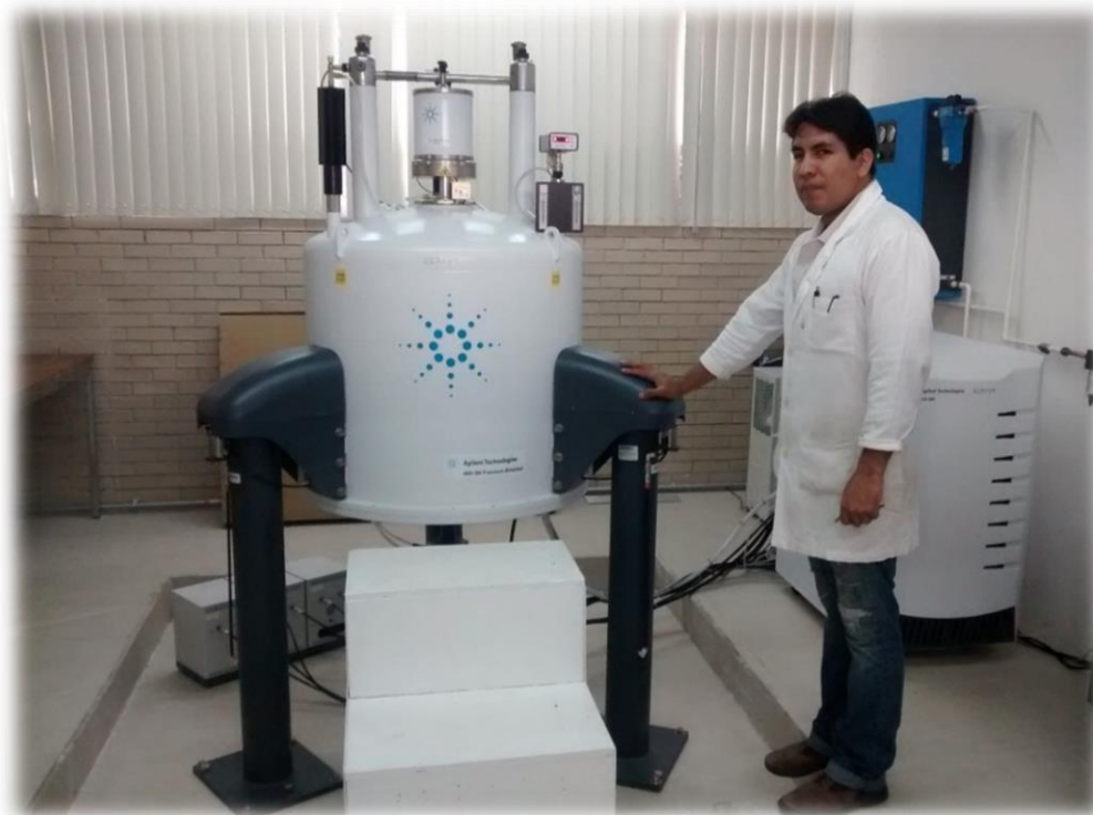
Figura 2. Equipo de Resonancia Magnética Nuclear modelo 400 MR DD2 Agilent.
