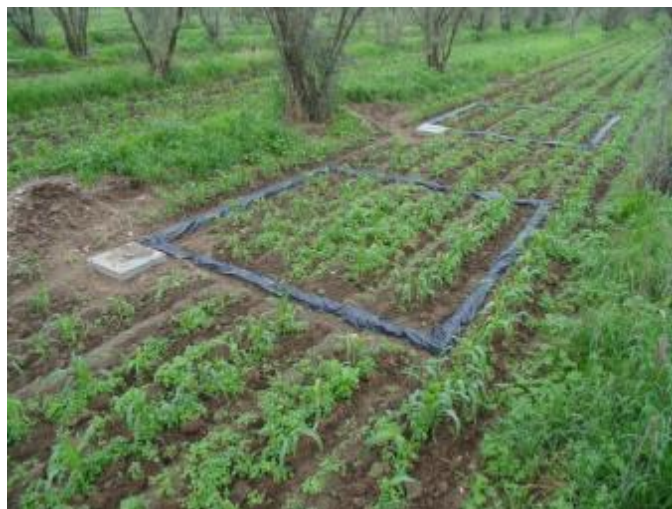
Figura 11. Parcelas establecidas para la determinación del escurrimiento y la pérdida de suelo por erosión hídrica.
