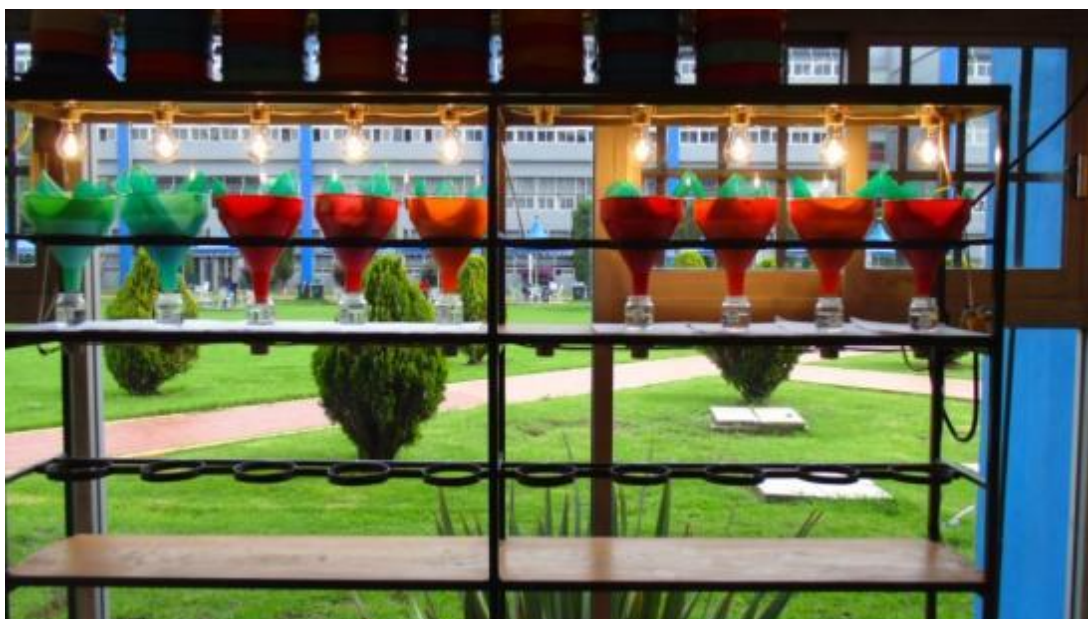
Figura 10. Montaje del método Berlese modificado por Tullgren para la extracción de la mesofauna del suelo.
