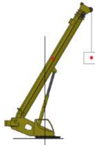
Figura 34 Distancias entre centros de gravedad de la carga y pluma
