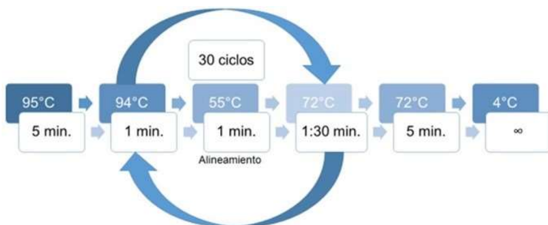
Figura 7. Condiciones estandarizadas de termociclaje para la amplificación del gen PR a través de la técnica de PCR punto final.
