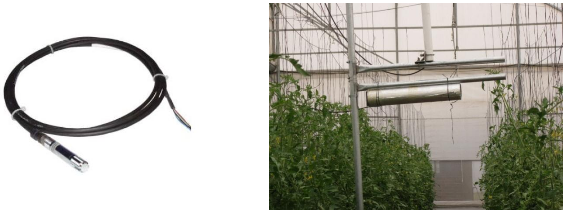
Fig. 4.4. Sensor de temperatura y humedad relativa HMP50 y detalle de la instalación.
