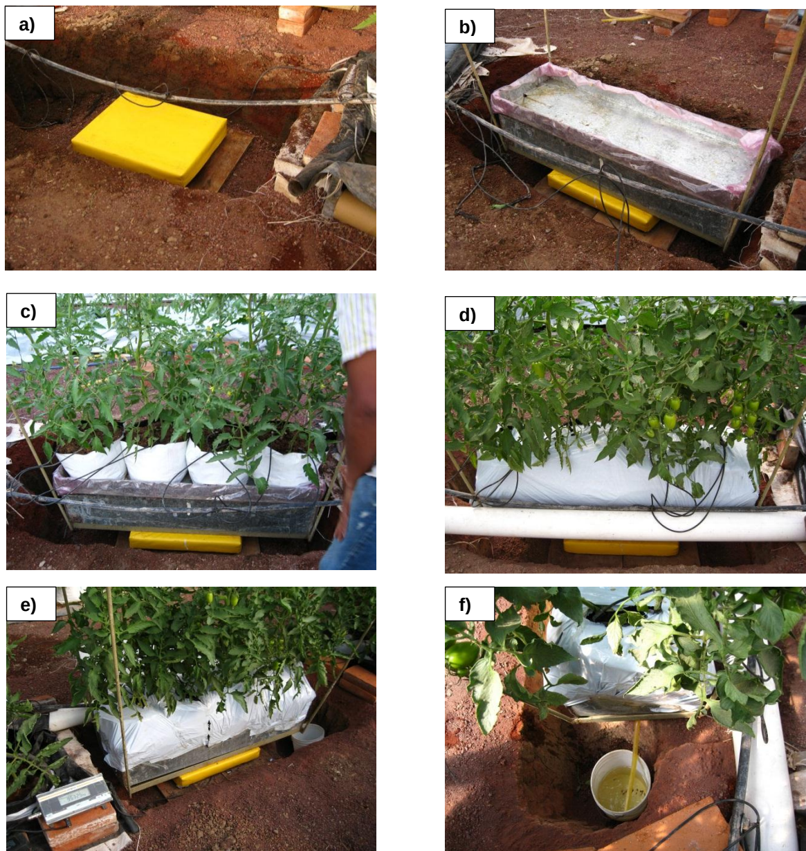
Fig. 4.8. Pasos para la instalación de la balanza electrónica para medir la transpiración del cultivo.
