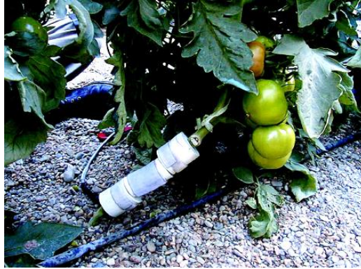
Fig.2.5. Sensor de flujo de savia.
