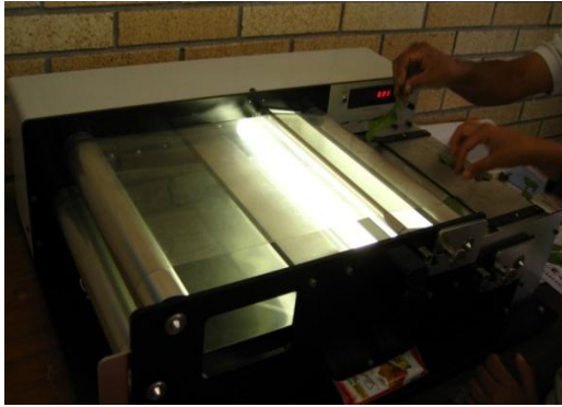
Fig. 4.10. Determinación de área foliar (LI-COR modelo LI-3100) y medición de las dimensiones de las hojas.
