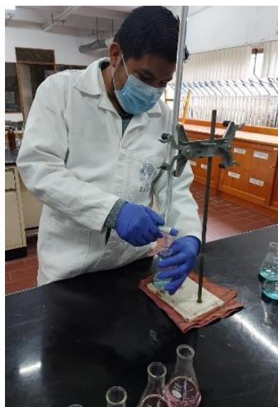
Figura 6. Titulación de los extractos de nitrógeno (N) para café ‘Geisha enana’.
