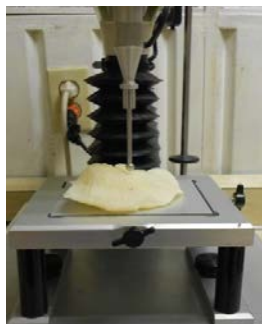
Figura 20. Texturómetro TATX2i en la determinación de firmeza de hongo seta.
