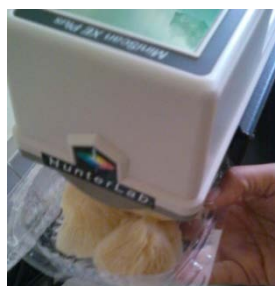
Figura 19. Medición de color en hongo seta, con colorímetro Hunter Lab.
