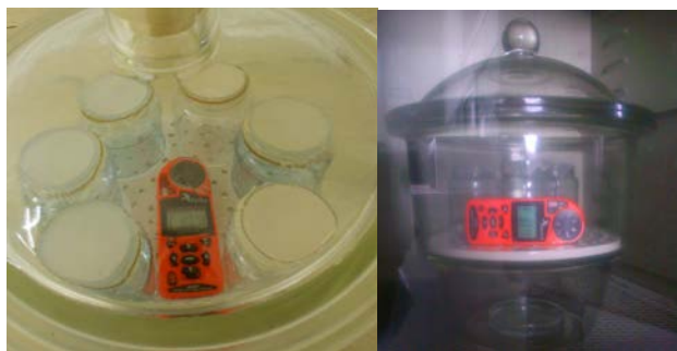
Figura 8. Celdas de permeabilidad para la determinación de PVA de las películas.
