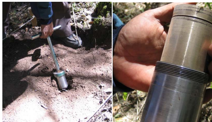
Figura 6. Barrena de doble cilindro para determinación de densidad aparente.
