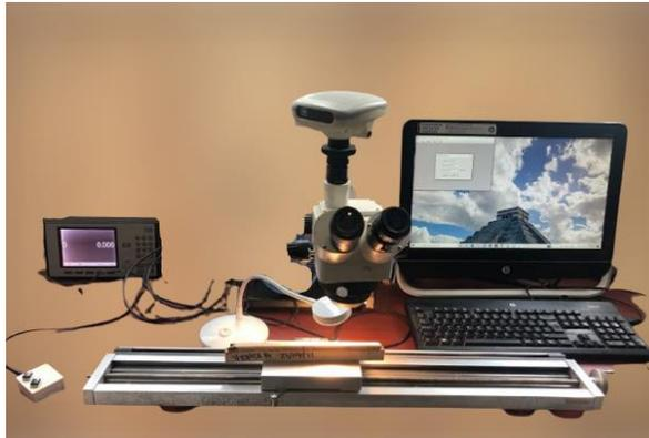
**Figura 8. Sistema de medición VELMEX, utilizando en el proceso de medición de las muestras dendrocronológicas.**
