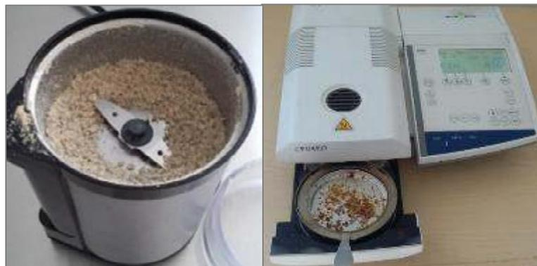
Figura 10. Analizador halógeno de humedad.
