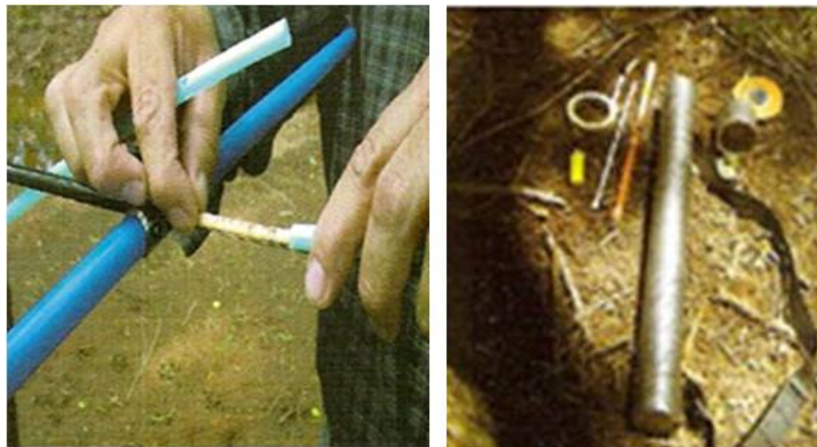
Figura 6. El núcleo de crecimiento inmediatamente después de su extracción se coloca en un popote de plástico, al cual se le anota la clave del sitio, fecha de colecta, diámetro del árbol y otras observaciones. A la derecha se muestra el tubo en el cual se guardan las muestras para su cuidado durante el transporte.
