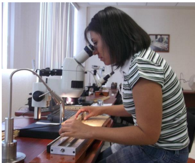
Figura 2. Medición de muestras empleando el sistema de medición VELMEX con precisión de 0.001 mm.
