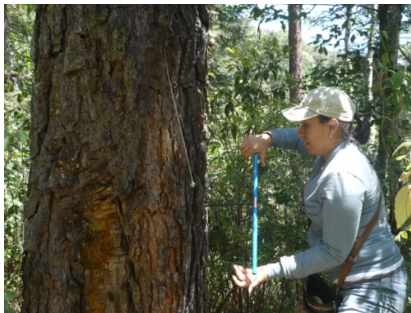
Figura 4. Ejemplo de la toma de muestras de crecimientos de Pinus patula empleando el taladro tipo Pressler.
