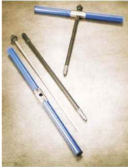
Figura 3. Componentes del taladro Pressler (Grissino-Mayer).
