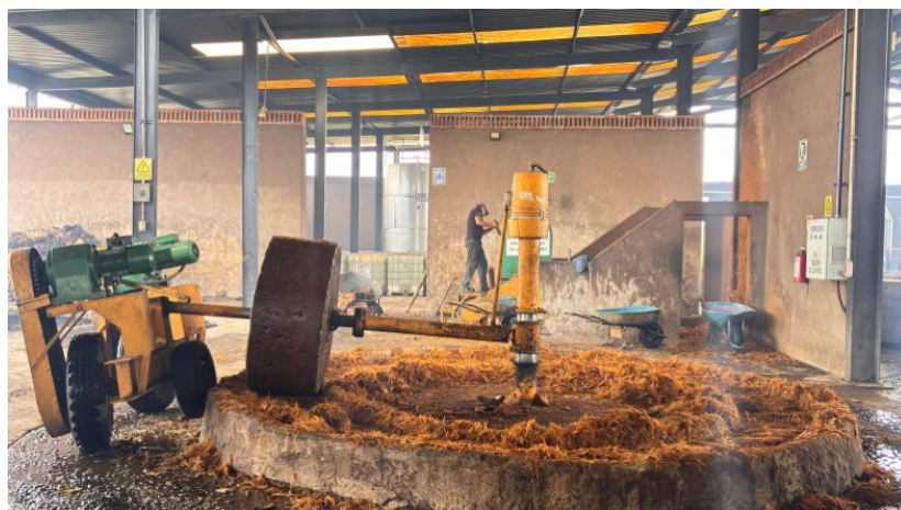
Figura 26. Molienda de las fibras de agave mediante tahona de piedra de cantera, accionada por un motor.
