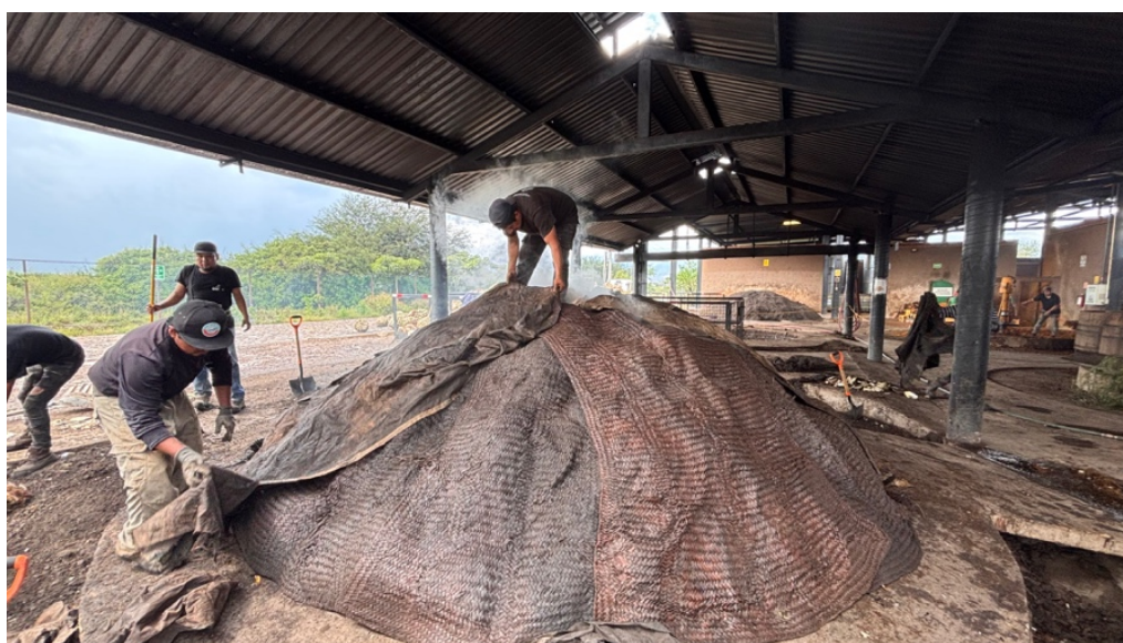
Figura 20. Tapado del horno con materiales (petates, lonas de plástico, tierra y llojuela) que favorecen la cocción de las piñas de agave.
