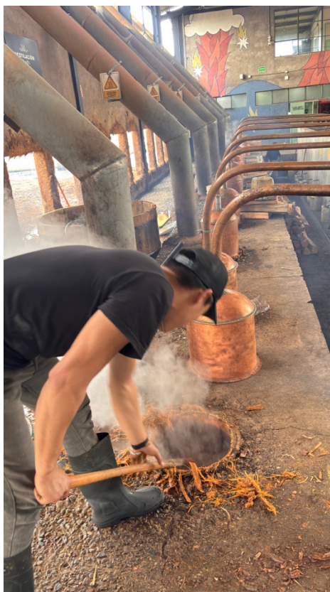
Figura 29. Destilación del mosto fermentado de Agave angustifolia en alambiques de cobre.
