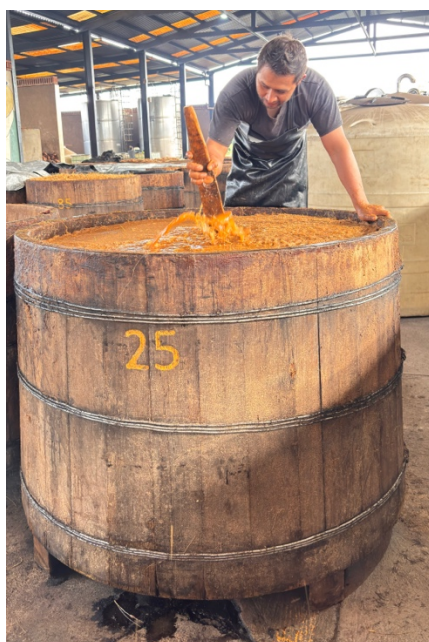
Figura 28. Formulación de las tinas de fermentación mediante la compactación del bagazo de Agave angustifolia .
