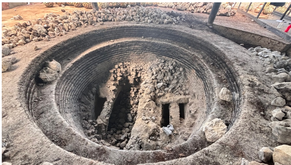
Figura 18. Horno de bóveda utilizado para cocer piñas de agave.
