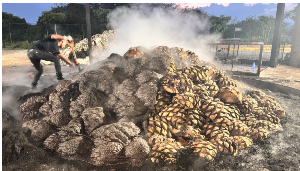
Figura 24. Destapado del horno tras el tiempo de cocción establecido.
