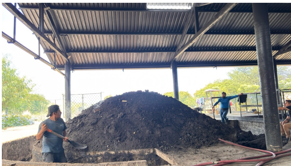
Figura 21. Hidratación del horno de bóveda durante el segundo día de cocción.
