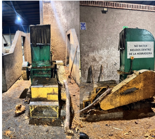
Figura 25. Primera molienda de piñas cocidas en hebradora de agave.
