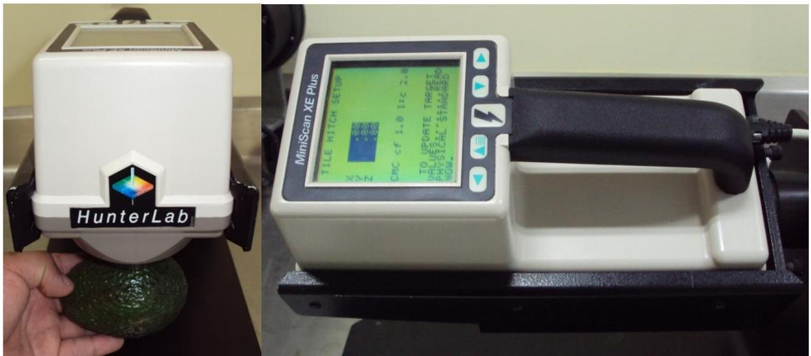
Figura 8. Determinación de las variables  $L^*$ ,  $a^*$  y  $b^*$  por medio del colorímetro Hunter Lab.
