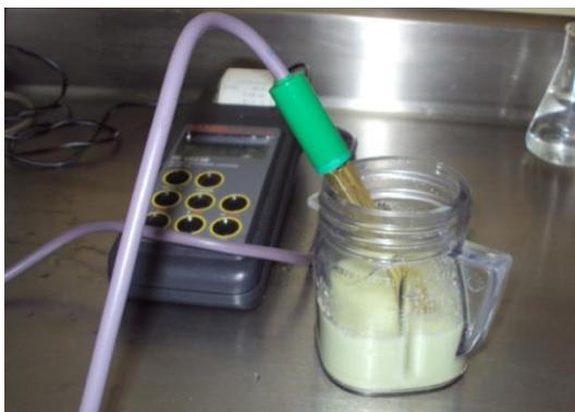
Figura 13. Determinación de pH por medio de potenciómetro portátil.
