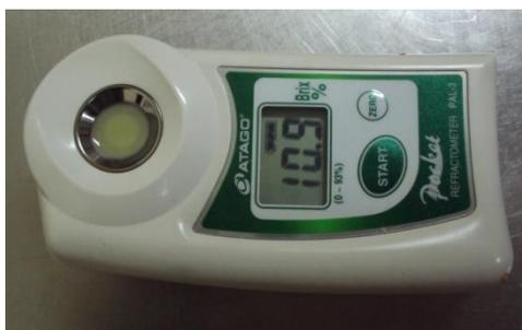
Figura 15. Determinación de SST por medio de refractometría.
