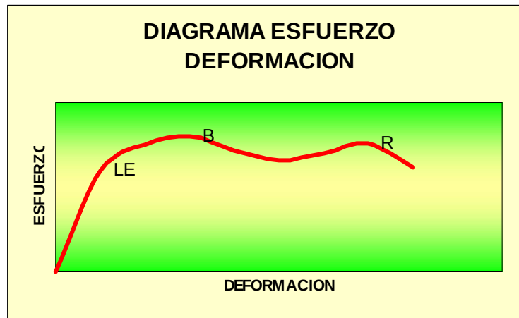
Figura 4. Curva de esfuerzo-deformación de un material biológico, LE, límite elástico, B, punto de biocedencia y R, punto de ruptura.
