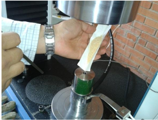
Figura 9. Suministro de aserrín dentro del cilindro de formación
