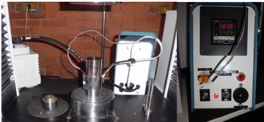
Figura 8. Control de temperatura con termocople tipo J
