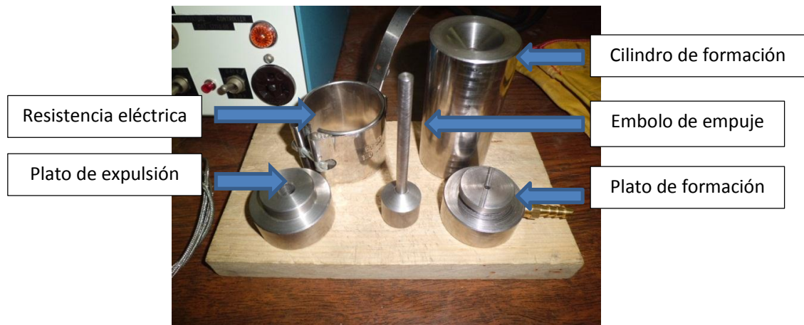
Figura 3. Molde unitario experimental para fabricación de pellets.
