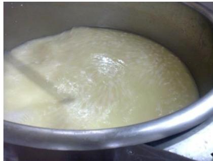
**Figura 9.** Segundo trabajo del grano, con aumento de temperatura hasta 38 °C.
