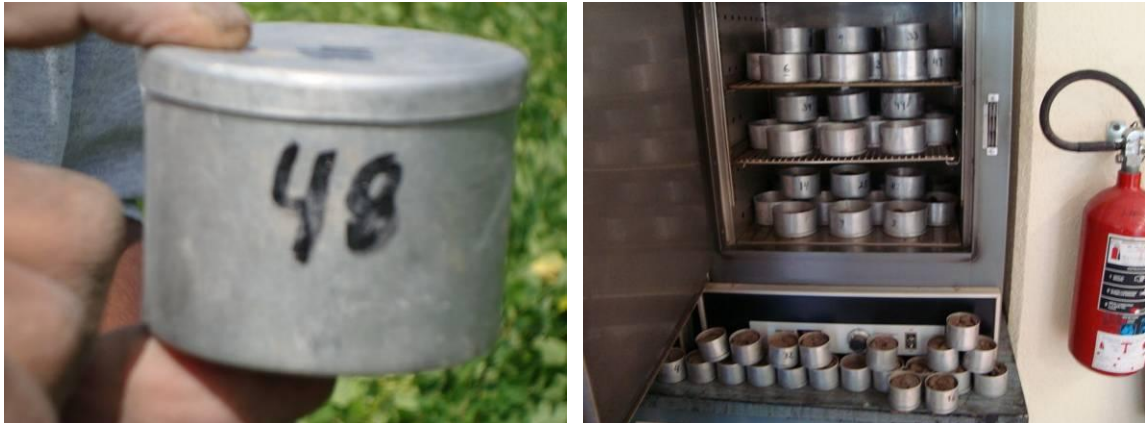
Figura 10. Traslado y secado de la muestra para la determinación de humedad gravimétrica y densidad aparente.
