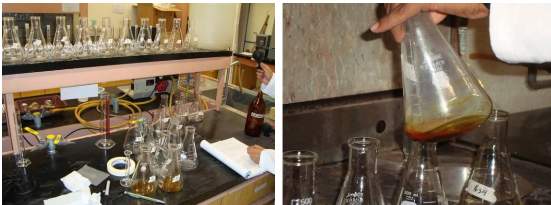
Figura 14. Determinación de materia orgánica por el método de Walkley y Black.
