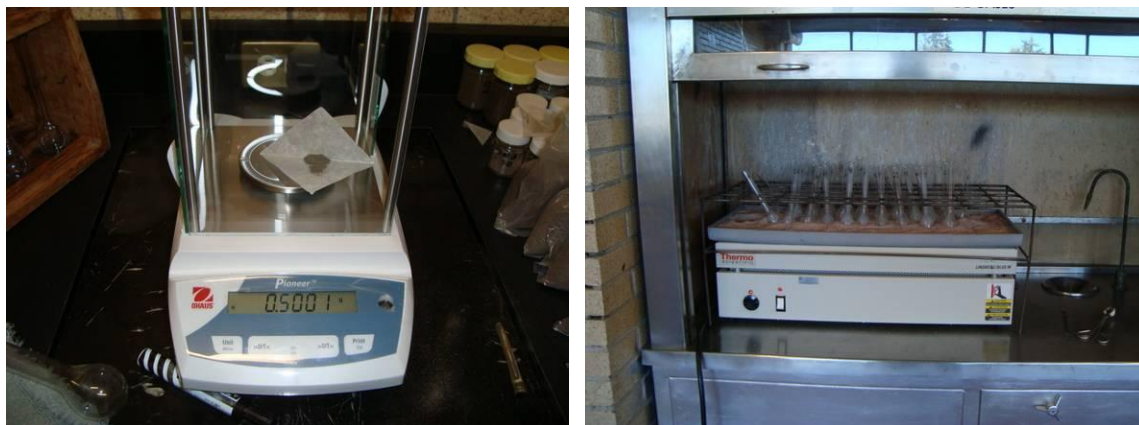
Figura 15. Pesado y digestado del muestra de suelo para la determinación de NT.
