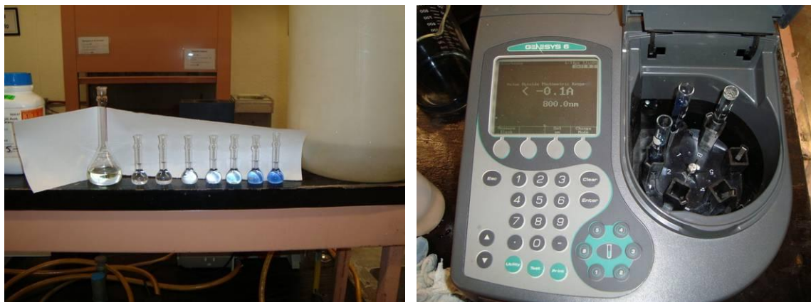
Figura 17. Preparación de la curva de calibración y lectura de las muestras para fósforo extractable.
