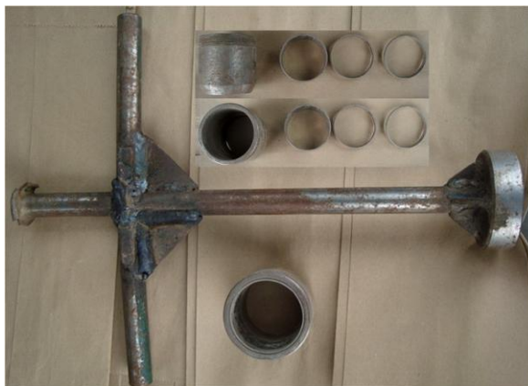
Figura 12. Barrena de doble cilindro modificada para condiciones de Chapingo, México.
