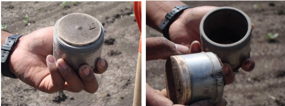
Figura 9. Extracción de la muestra de suelo para la determinación de humedad gravimétrica y densidad aparente.
