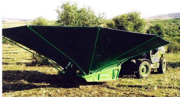
**Figura 10. Cosechadora de frutas del tipo paraguas invertido.**
