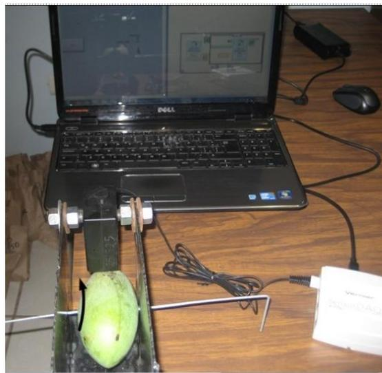
**Figura 6. Registro del momento flector de desprendimiento en el ordenador.**
