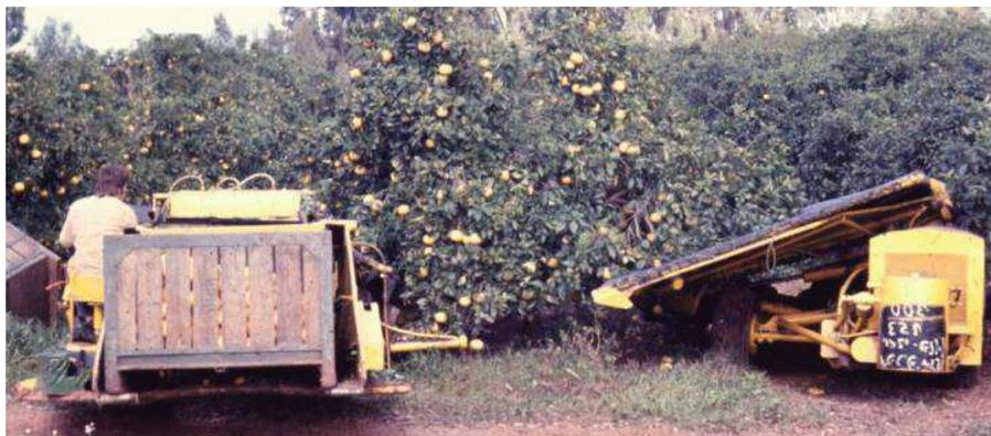
**Figura 11. Sistema de cosecha de dos plataformas.**
