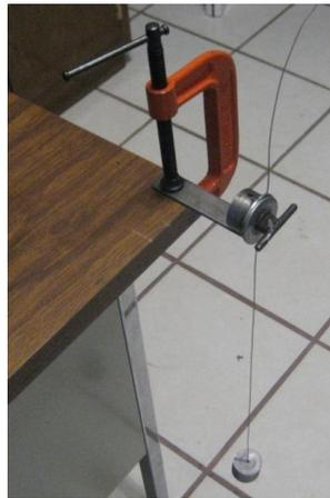
**Figura 4. Péndulo torsional para determinar el momento de inercia del cilindro patrón.**
