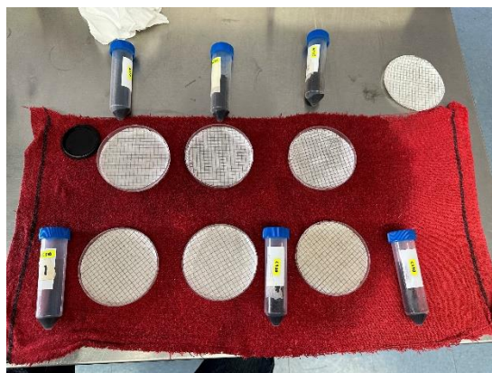
Figura 3. Filtrado de esporas y cuantificación.
