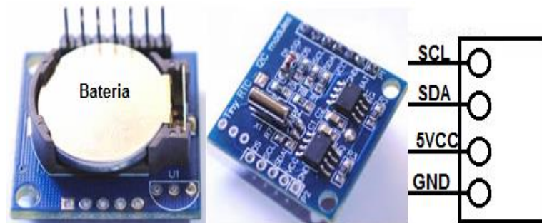
Figura 33. Parte física y esquema de conexión del RTC.
