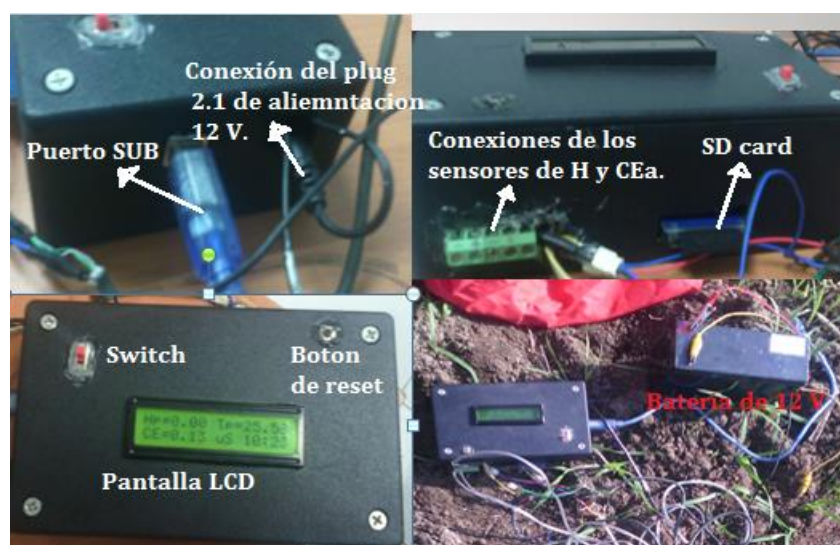
Figura 48. Partes físicas importantes del equipo construido.
