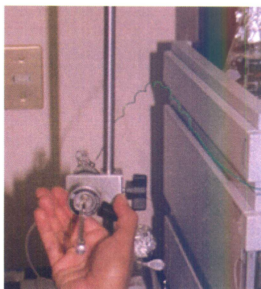
Figura 12. Inyección de la muestra en HPLC.
