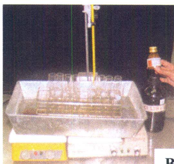
Figura 9. Desdoblamiento de almidón: (A) baño maría, (B) adición de amilasas y HCl, (C) ajuste de pH.
