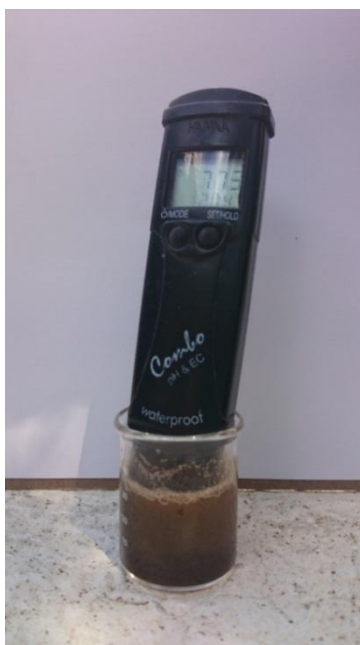
Figura 23. Sensor de conductividad eléctrica y pH.
