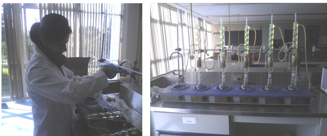
Figura 12. Montaje del equipo de extracción Soxhlet de 250 ml.
