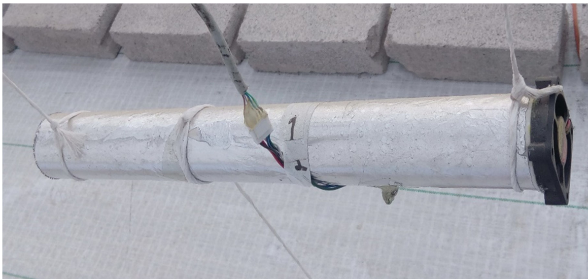
Figura 3.8 Sensor alámbrico protegido e instalado en el invernadero
