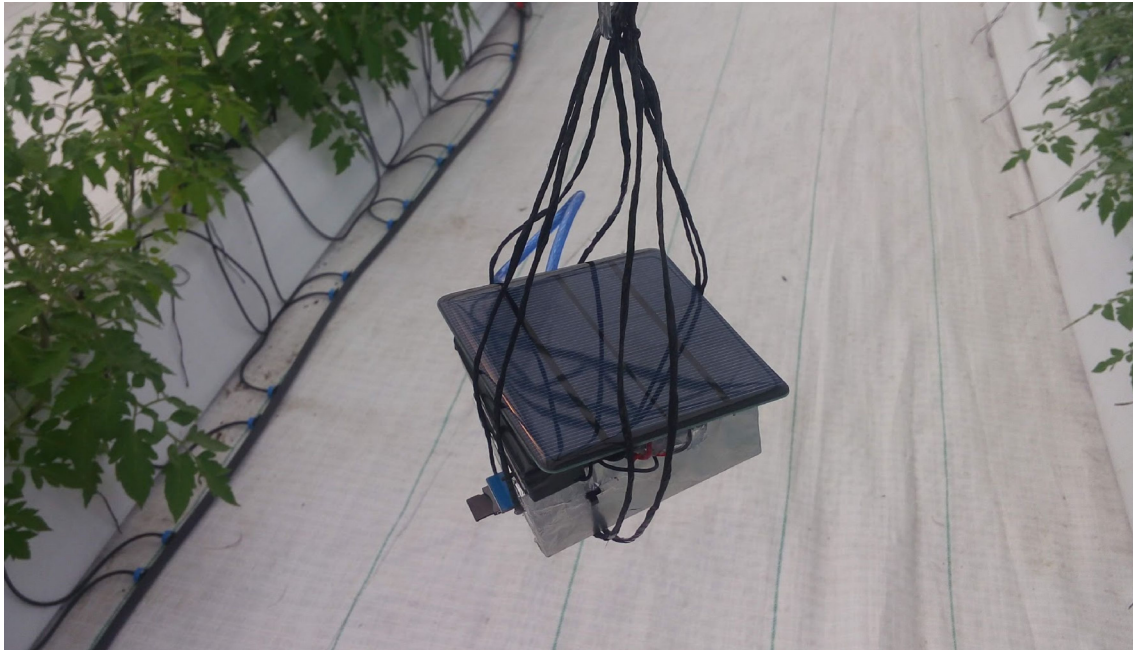
Figura 3.4. Nodo sensor de la red inalámbrica para monitoreo del clima de un invernadero
