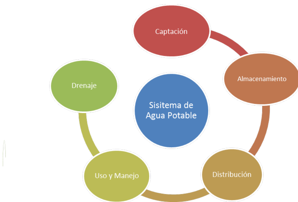
Figura 5 Componentes del Sistema de agua potable
