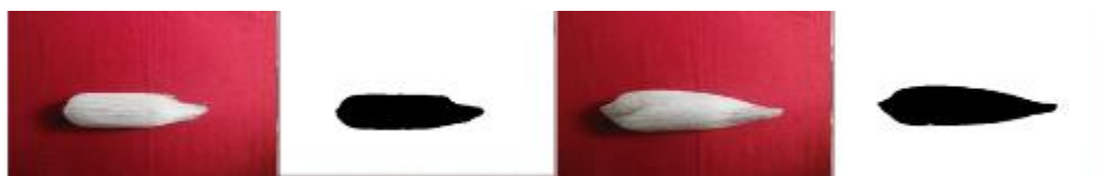
Figura 57. Procesamiento de Mazorcas en OpenCV para determinar el área en pixeles negros.
