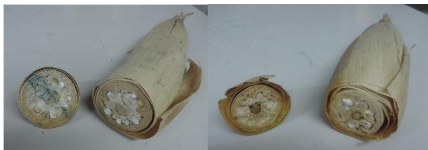
Figura 89. Calidad de corte por el sistema de corte con control automático con visión artificial.
