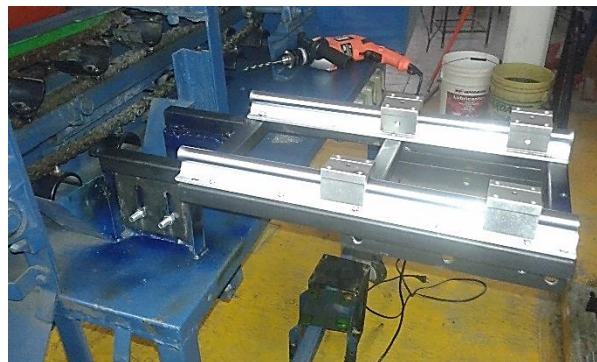
Figura 36. Soporte con los carriles y chumaceras lineales.
