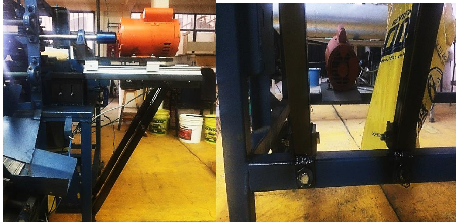
Figura 40. Barras a apoyo colocadas y acopladas al chasis con soportes cuadrados.
