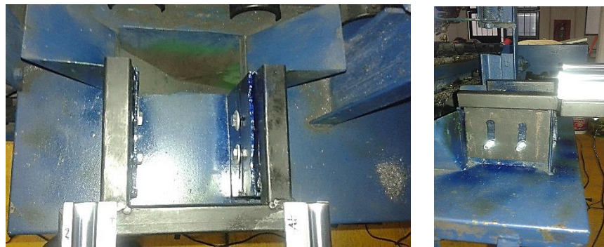
Figura 35. Soporte empotrado a la máquina cortadora de mazorcas.
