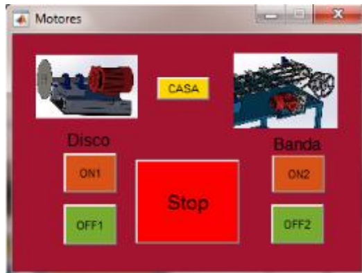
Figura A2. Panel de calibración de los motores del disco de corte y la banda transportadora.
