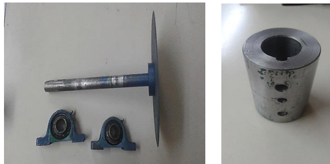
Figura 42. Eje del disco de corte, chumaceras y unión de acero.
