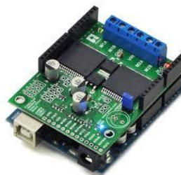
Figura 28. Acoplamiento de la tarjeta VNH5019 con el Arduino UNO.
