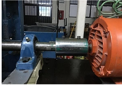
Figura 43. Empotramiento del eje del disco con el motor.
