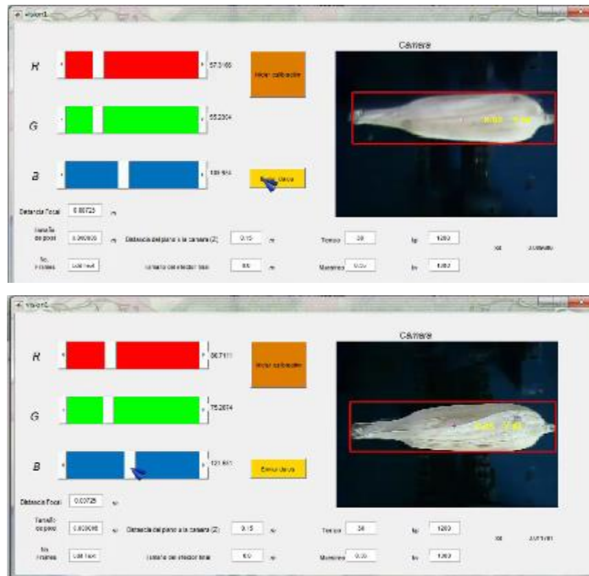
Figura 82. GUI para la localización de mazorcas y parámetros en MATLAB.
