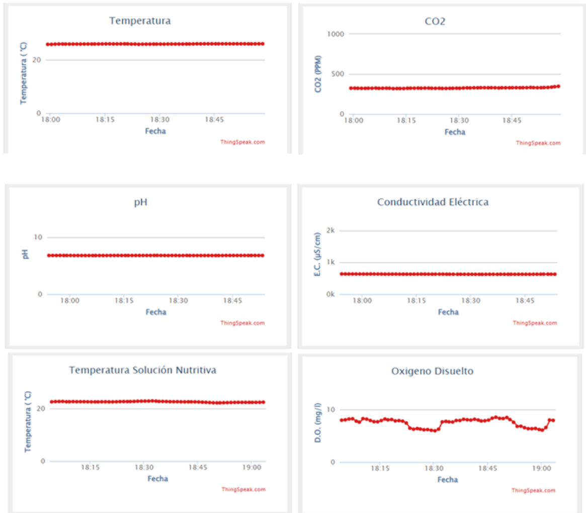
Figura 4-4. Capturas de pantalla del sitio web ThingSpeak de datos de temperatura del aire, CO 2 , pH, conductividad eléctrica, temperatura de la S.N. y oxígeno disuelto.
