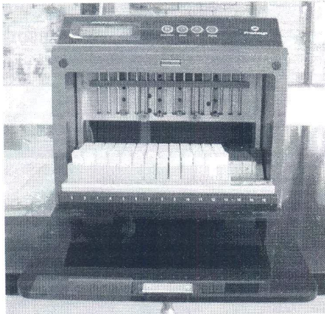
Figura 3. Aparato para la extracción de DNA, modelo "Maxwell 16 System for Genomic DNA Purification", marca PROMEGA.
