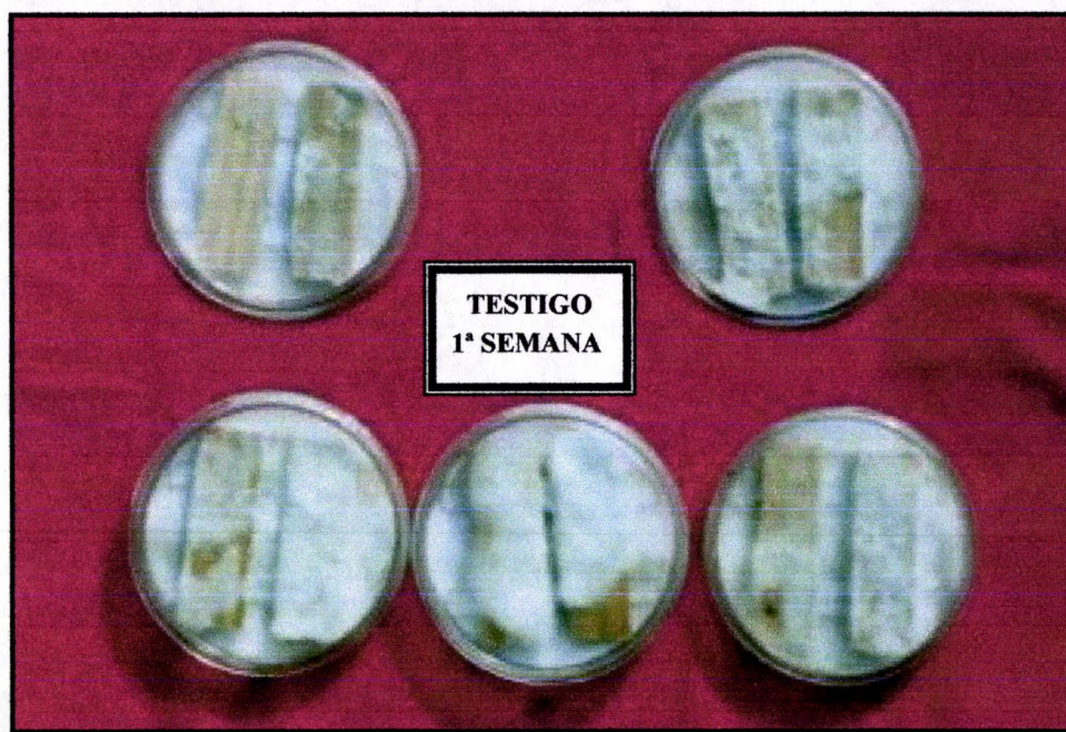
Figura 11. Estado de las probetas testigo a la primera semana de inoculación.
