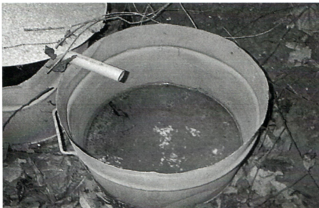
Figura 9. Captadores de escurrimiento de agua de lluvia y pérdida de suelo colocados en las cuatro parcelas en Chapa de Mota, Estado de México. Año 2002.
