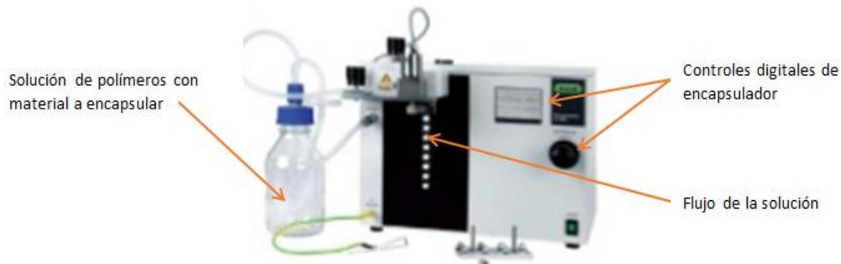
**Figura 6. Equipo en el que se elaboraron las cápsulas (en bicapa y en combinación de polímeros); Microencapsulador BÜCHI**
