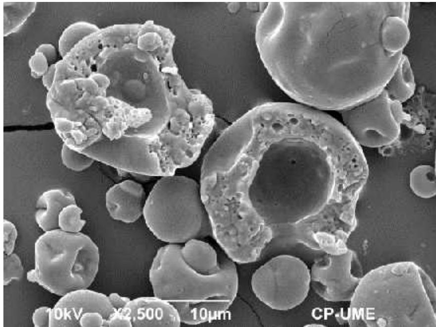
Figura 15. Micrografía Electrónica de Barrido de la estructura interna de una microcápsula.  $M_{WPC-PT55}$  3:1.
