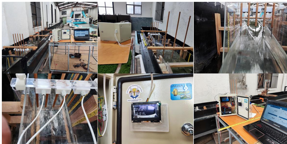
Figura 3.10. Sistema de medición desarrollado e instalado en el aforador de garganta larga.
