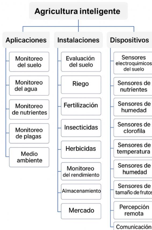
Figura 2.13. Aplicaciones, instalaciones y dispositivos en la agricultura inteligente basada en IoT (Fuente: Dhanaraju et al. (2022))
