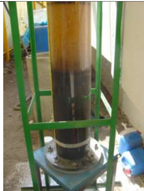
Reactor y manto de lodo en el fondo
