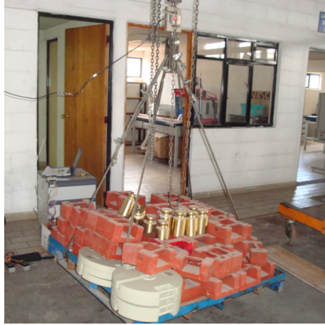
Figura 4.12: Calibración del dinamómetro de tensión.
