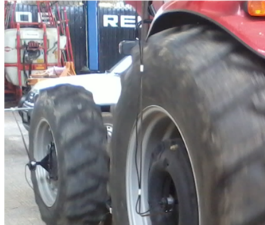
Figura 4.8: Instalación de los sensores de rotación en las ruedas delanteras y traseras.
