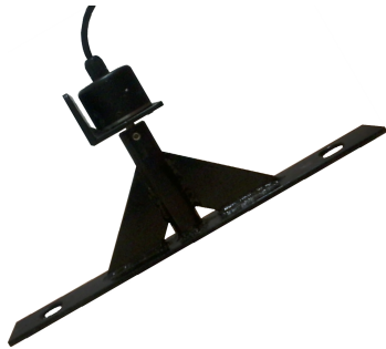
Figura 4.8: Instalación de los sensores de rotación en las ruedas delanteras y traseras.
